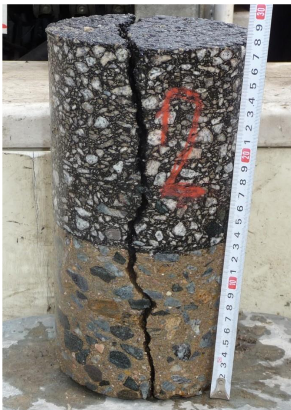
Obrázky 8, 9 – Vývrty vozovky v miestach reflexných trhlín
