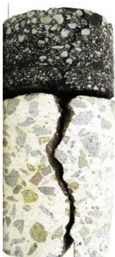
Obrázky 8, 9 – Vývrty vozovky v miestach reflexných trhlín
